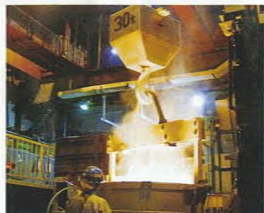
▲1600℃の溶湯上の酷熱環境での計量を世界で初めて実現した電子式高精度吊り秤「コナー7」。自動車エンジンの性能が一変した
