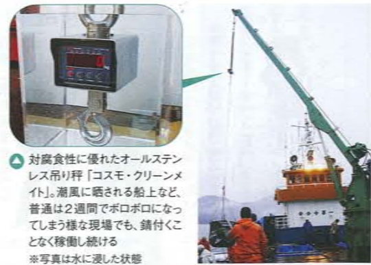
▲100tまで計量可能な国内最大級の吊り秤「ニューコスモ」。90tを超える船舶用スクルーなどの計量に使用される
