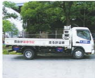
▲トラックの荷台そのものに秤の機能を持たせた「ロッキー」。計量した荷物を積み替えることなくそのまま運搬できる。まさに移動式秤の真骨頂
