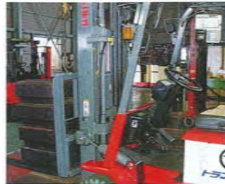
▲フォークリフトに計量機能をもたせたフォークリフトスケール「マーキュリー」。数々の現場で多大なコスト削減効果をもたらしている
