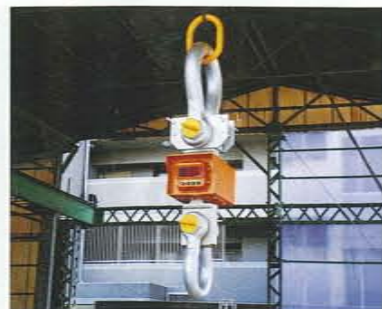
▲100tまで計量可能な国内最大級の吊り秤「ニューコスモ」。90tを超える船舶用スクルーなどの計量に使用される
