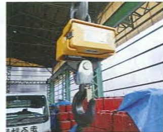
▲計量結果を手元まで無線で知らせる「コスモランサム」。秤に無線技術が30年前に業界に導入したのも同社が初めて
